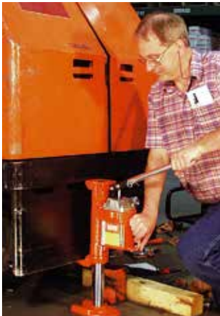
J-sarjan varvasnostin on erittäin vankka. Tässä nostetaan trukkia huoltoa varten.
