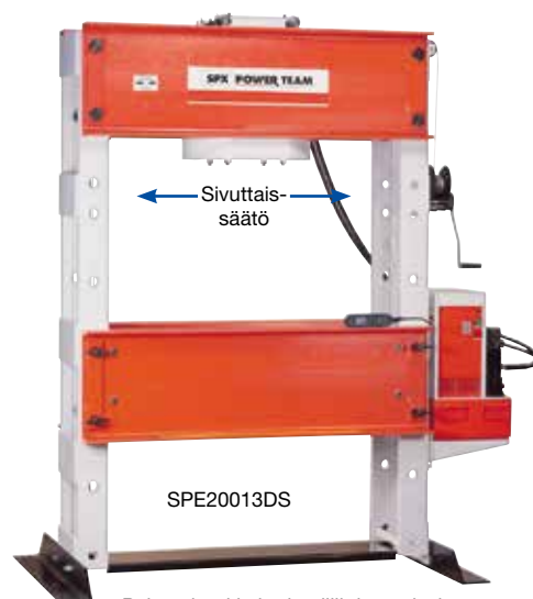
Painemittari ja hydrauliliittimet sisäl-tyvät puristimen toimitukseen
