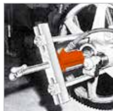
Hydraulinen tankoulosovedin irrottaa vetopyörän. Vetopyörä sovitte helpottaa vetoa.
