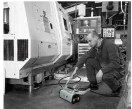
Koneen nostaminen sylinterin ja kauko-ohjattavan paineilmahydraulin pumppun avulla.
