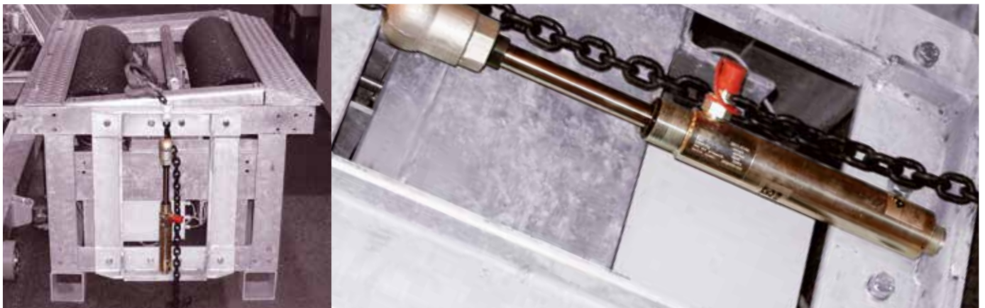
Sylinteri CPF705 ja sopiva työntöpää asennettu kuorma-auton jarrujen testausta varten.
