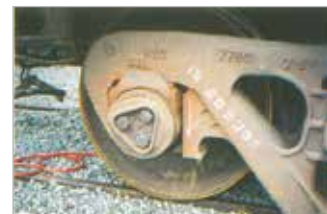
Laakeriulosvedin on ihanteellinen työkalu kun pitää vaihtaa rautatievaunujen kuluneita laakereita.
