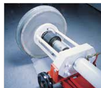
Laakeriulosvedin valmiiksi aseteltuna laakerin vaihtoa varten
