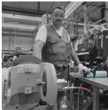
Teollisuusrobotin niveleen asennetaan tiivistysrengasta. Apuvälineinä ovat reikäsyylinteri ja paineilmahydraulinen pumppu.
