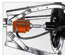
3-jalka ulosvedin hoitaa pidon sillä aikaa kun käsipumpun voimalla työntötanko työntää akselia irti kappaleesta. Työntöpää suojaa työntötangon päätä.
