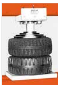
Puristetaan vanne vanhasta renkaasta uuteen käyttäen Power Team puristinta
