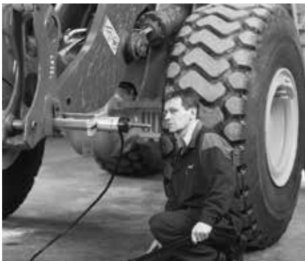
Puslan vaihto reikäsyylinteriä ja käsipumpua käyttäen.
