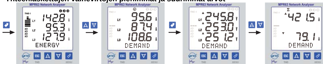
Kuva 62: Yhteenlaskettujen vaihevirtojen minimi- ja maksimiarvot
